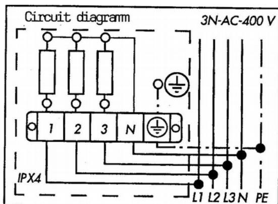
Перед подключением нагревателя для сауны проверьте отдельные трубчатые нагревательные элементы и клеммы подключения к сети на надежность посадки! (При необходимости, подтяните болты!)
